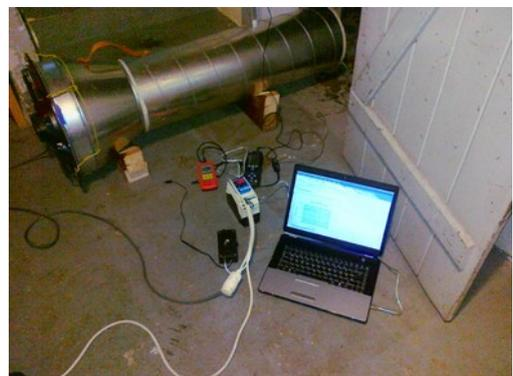
**Seit Einführung des GEG in 2020 muss zwingend** sowohl mit Über- als auch mit Unterdruck gemessen werden.
